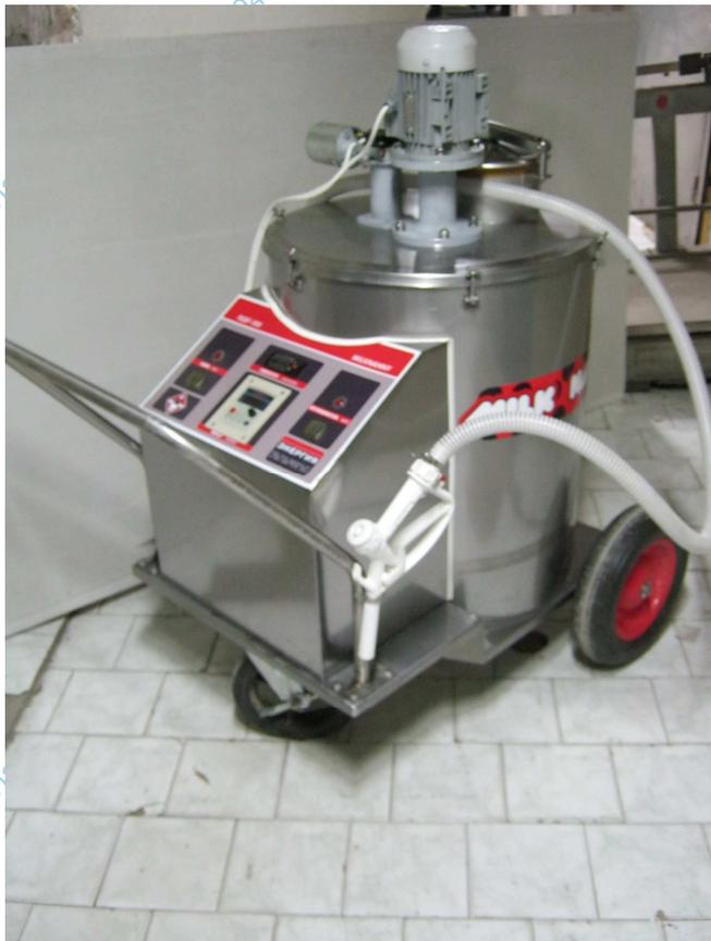
Молочное такси позволяет обрабатывать разные виды жидкости - и цельное молоко, и его заменители. Не составляет проблемы установить как температуру пастеризации, так и желаемого охлаждения. Заливать жидкость и задавать цикл можно на ночь.
