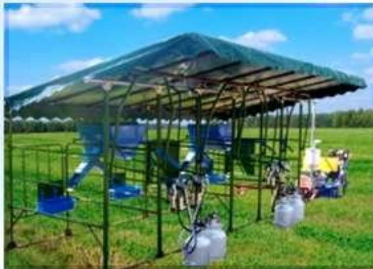
Установки предназначены для доения коров на пастбищах и в доильных залах коровника в станках параллельно-проходного типа. Пастбищные доильные установки выпускаются для доения как в переносные ведра, так и в молокопровод.
