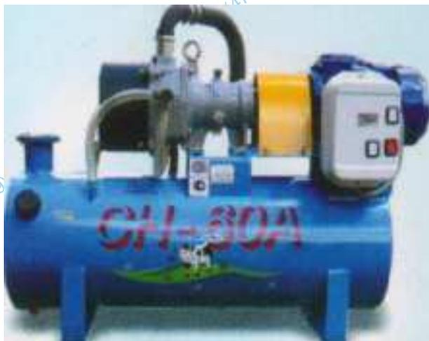
Предназначена для создания вакуумметрического давления в системах машинного доения коров, а так же в других отраслях народного хозяйства, процессы которых требуют вакуумметрического давления.
