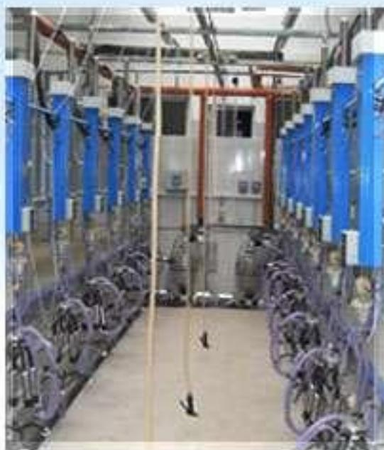
Установка доильная автоматизированная УД-Е типа "Елочка" выпускается двух модификаций:
